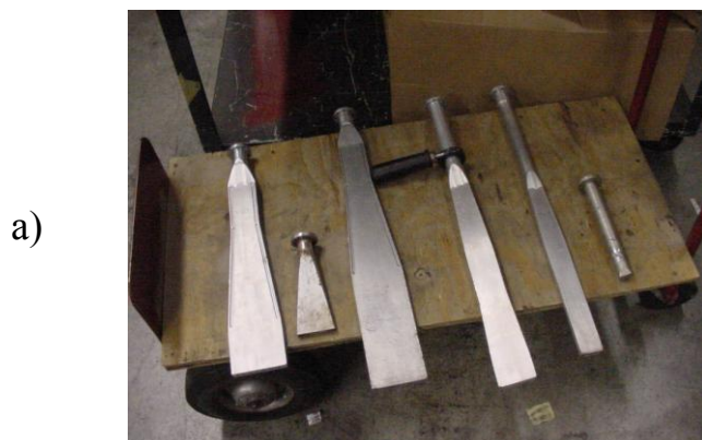
Рис. 2. Виды сопел, формирующих поток гранул в среде газа, в зависимости от поверхности и площади очистки: а) единичные; б) комбинированные для интенсификации процесса очистки
