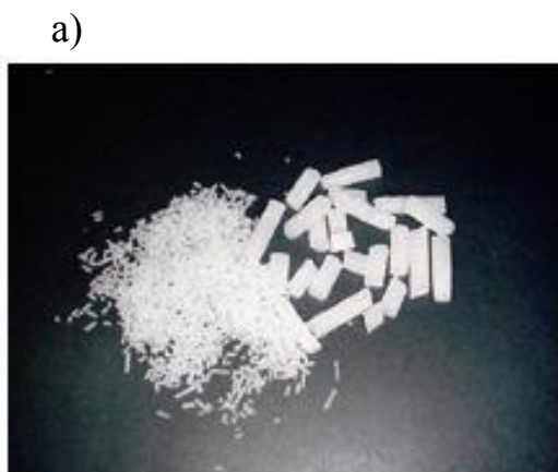
Рис. 1. а) гранулы твердого диоксида углерода; б) аппарат для бластинга (генератор потока гранул)
