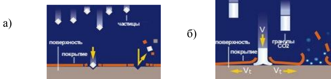
Рис. 3. Воздействие на покрытие и очищаемую поверхность от покрытия, при: а) очистке абразивными материалами (песок, пластик, стекло и т.д.); б) очистке диоксидом углерода гранулированным
